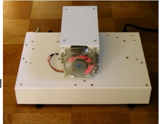
出力段のバイアスは多目に  $400\text{mA}$  ほど流して A 級動作範囲の拡大と微小領域でのリニアリティを改善していて、高電源電圧とバイアス電流による発熱はトンネル型の大型放熱器に超静音ファンの組合せで静音性と安定性を確保しています。
