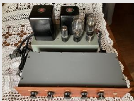
小笠原会員 ・2A3 シングルアンプ ・サンスイ HTR200 型プリアンプ
