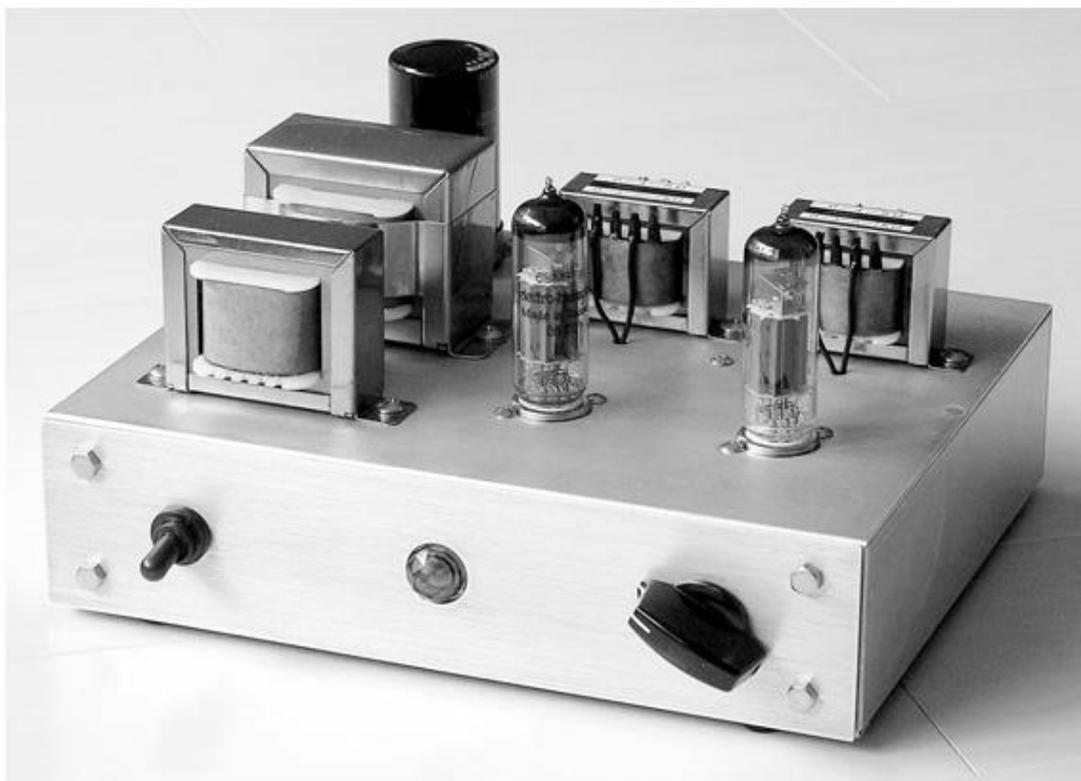
写真1.1 完成した6BM8シングル・ステレオ・アンプ
